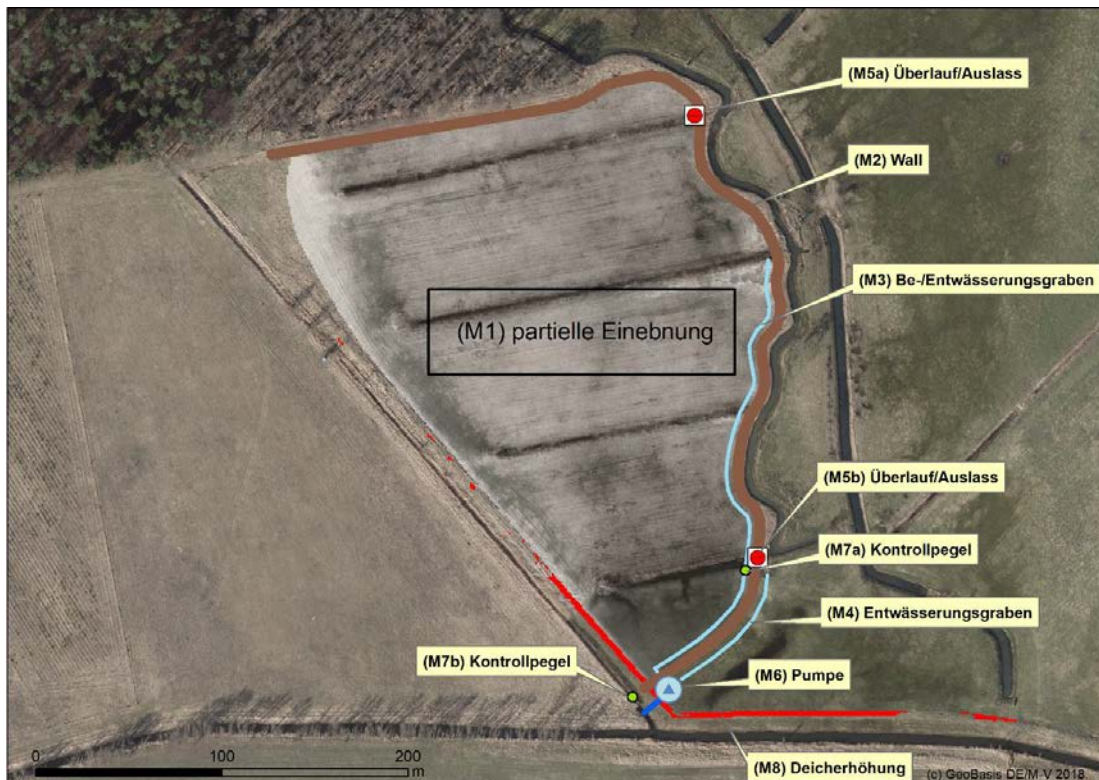
Abbildung 34: Plan für die Einrichtung des CW Ziese-Mühlgraben
